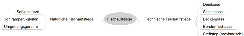
Abbildung 2.3: Typen von technischen und naturnahen Fischaufstiegen.
